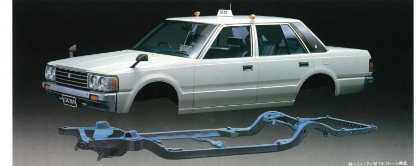
新フルフレーム構造採用。頑丈でしなやか。優れた耐久性、静粛性を誇ります。クラウン伝統のペリメーター型フレーム。その強度、剛性をさらに高めた新フルフレーム構造を採用しています。衝撃、ねじれ、ひずみなどに比類のない強さを発揮する強固な骨。ボディとの間に防振ゴムを最適に配置し、走行時の振動や騒音をその発生源から巧みに解消。いちだんと静かな走りはもとより、快適な乗り心地を同時に実現しました。クラウンならではの卓越した走行性は、ここから生まれます。
